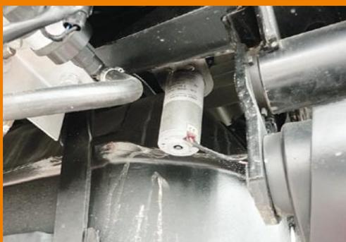
Die AdBlue-Pumpe sitzt am Harnstofftank und speist die Einspritzdüse über dem Auspuffrohr (re.)
